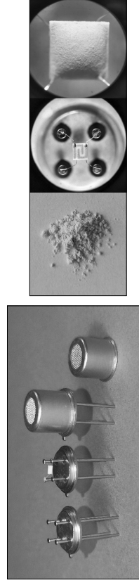
Рис. 1. Зовнішній вигляд газових сенсорів (а), та зовнішній вигляд напівпровідникового газочутливого шару (б)
